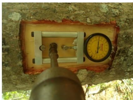
Figura 1. Realização da medição da DRL na madeira da espécie Spondias venulosa .
