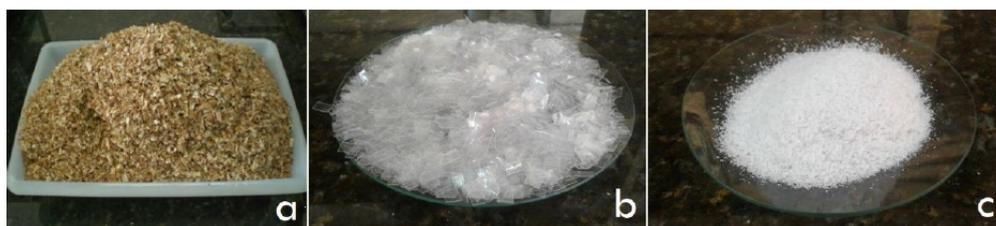
**Figura 1.** a) Maravalhas de teca; b) *Flakes* de PET; c) Partículas de PET.
