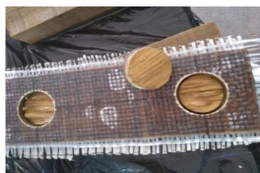
Figura 5. Corpos de prova após o ensaio *pull-off* a temperatura ambiente.
