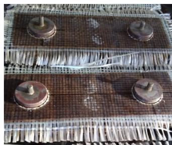
**Figura 2.** Corpos de prova com disco metálico colados.
