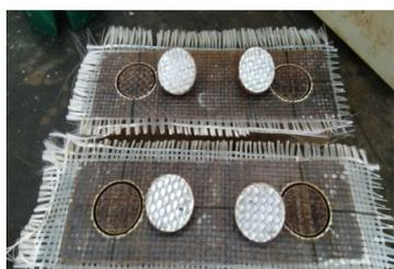
Figura 4. Corpos de prova após o ensaio *pull-off* a temperatura de 70 °C.
