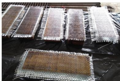
**Figura 1.** Corpos de prova com o compósito de fibra de vidro.
