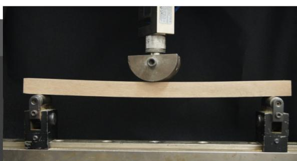
**Figura 2.** Ensaio de flexão estática na máquina de ensaio universal
