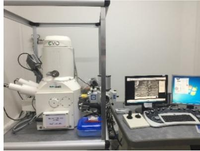
**Figura 2.** Equipamento utilizado para aquisição das imagens da superfície da madeira de *Pinus elliottii* após aplainamento com microscopia eletrônica de varredura
