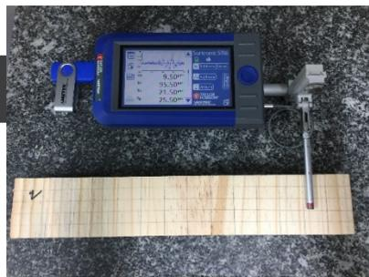
**Figura 1.** Determinação da rugosidade em madeira de *Pinus elliottii* com rugosímetro de arraste
