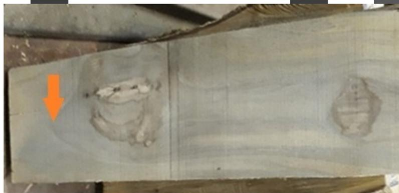
**Figura 1:** Corte longitudinal onde as manchas acinzentadas indicam a incidência de *Ceratocystis fimbriata* ao longo do fuste.
